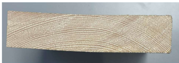
Figur 25: Treplanke som er sagd tangentielt.
