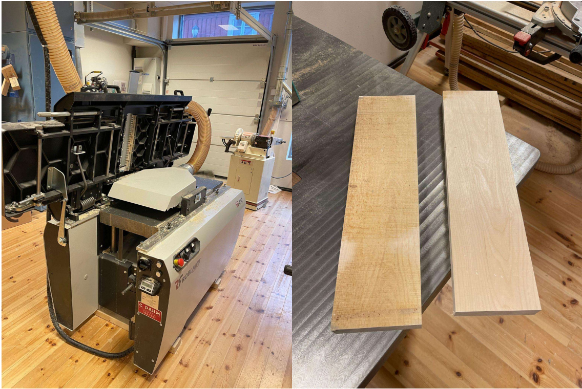
Figur 20: Bilder av plan- og tykkelseshøvel, og sammenligning av ubearbeidet og høvlet bjørk.
