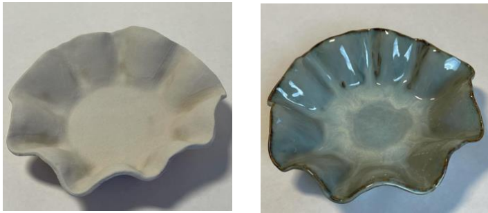
Figur 6: Her er PC-20 (Blue Rutile) påført først, og deretter er PCF-18(Honeydew) påført. Bildene viser formen før og etter glasurbrann. Den glaserte overflaten er i blågrønne nyanser. Bunnen er noe lysere og ytterkanten har blitt mørk brun. Overflaten har synlige kontraster og en prikket effekt i bunnen.
