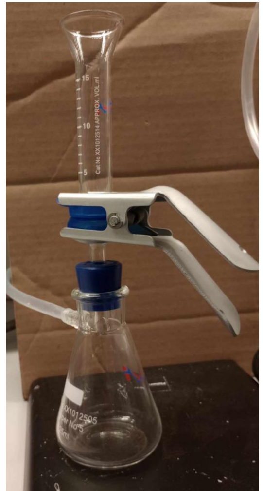
FIGUR 6: OPPSETTET FOR VAKUUMFILTRERING, INKLUDERT FUNNEL, BASE OG STOPPER, KLYPE OG SIDEARMS FLASKE. (FOTO: STYRVOLD, 2024)
