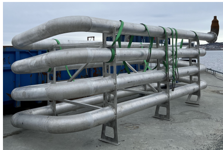
Figur 22: Veksler som senkes i sjøen under drift
