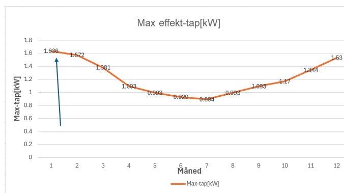
Figur 18: Max effekt-tap i (kW) per måned. Måned 1 er januar, trafo T04137.
