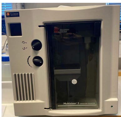
Figur 17: Figuren viser Coulter Counteren som ble benyttet til å telle antall partikler og måle partikkelstørrelse i vannprøvene. Bilde fra: Gruppen
