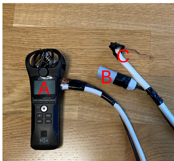
Figur 11: Oversikt over komponentene i målerigg 2: A: Diktafon, B: Hydrofon (HY-01), C: Jordingskabel (hvit).
