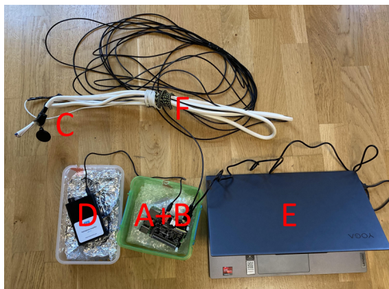
Figur 10: Målerigg 1: Oversikt over komponentene til målerigg 1; A: Raspberry Pi, B: Lydkort, C: Hydrofon HY-03, D: Forsterker, E: Strømforsyning, F: Jordingskabel (hvitkabel).
