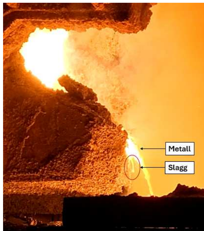
Figur 3.1: Bildet viser én av tapperennene til lysbueovnen. På bildet ser en det flytende slagget bak metallstrålen. Oppsamling av slagg i fast fase i enden av tapperenna, kalles “skjegg”
