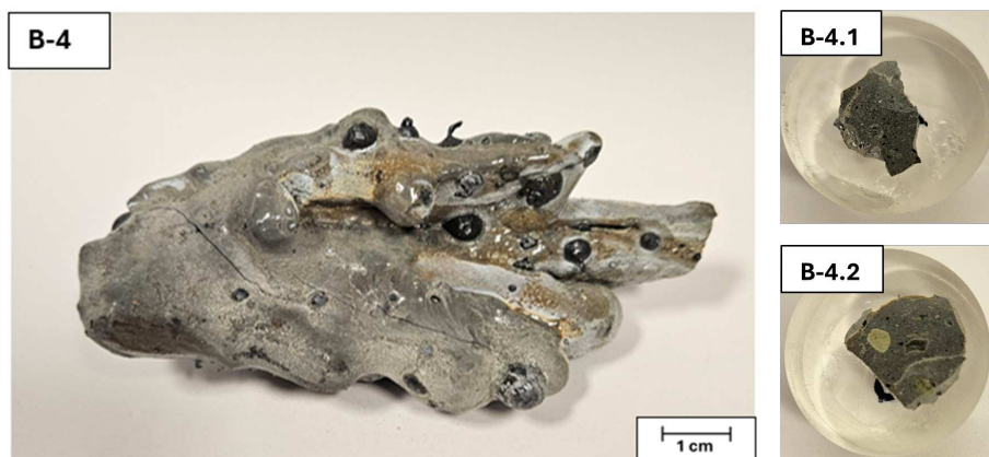
Figur C.10: Bildet til venstre viser slaggprøve B-4 sammen med de tilhørende delprøvene B-4.1 og B-4.2 , innstøpt i epoksy.
