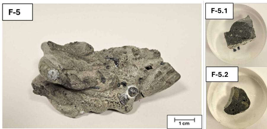
Figur C.13: Bildet til venstre viser slagprøve F-5 , samt de tilhørende delprøvene F-5.1 og F-5.2 , innstøpt i epoksy.
