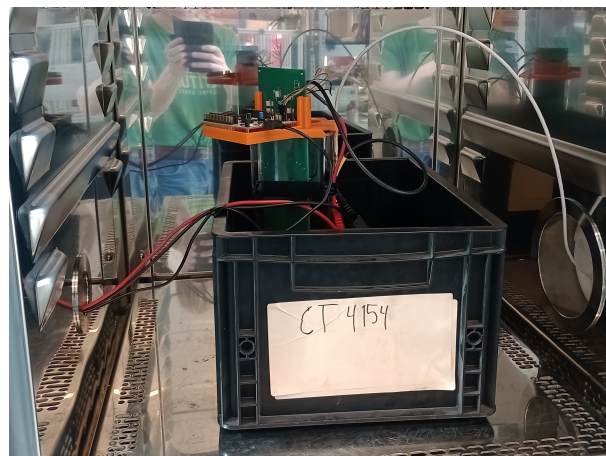
Figur 30: Testoppsett ved temperaturmåling.
