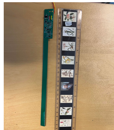
(b) Prototype med kapasitiv måling laget av Proserv.
