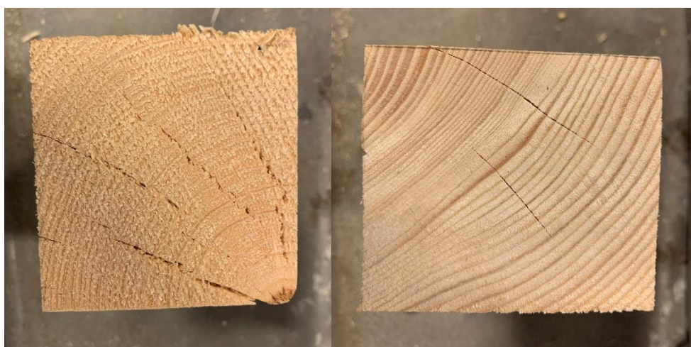
Bilde 20: Eksempler på sprekker fra prøver, foto: Kristin Nymark Rasmussen
