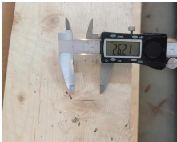
Bilde 6: Kvistdimensjon over 1/5 av trevirkets bredde av 10A-B.3, foto: Silje Hoem Johansen
