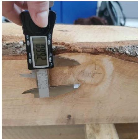
Bilde 10: Kvist med dimensjon over 1/5 av trevirkets bredde av X-Y, foto: Silje Hoem Johansen
