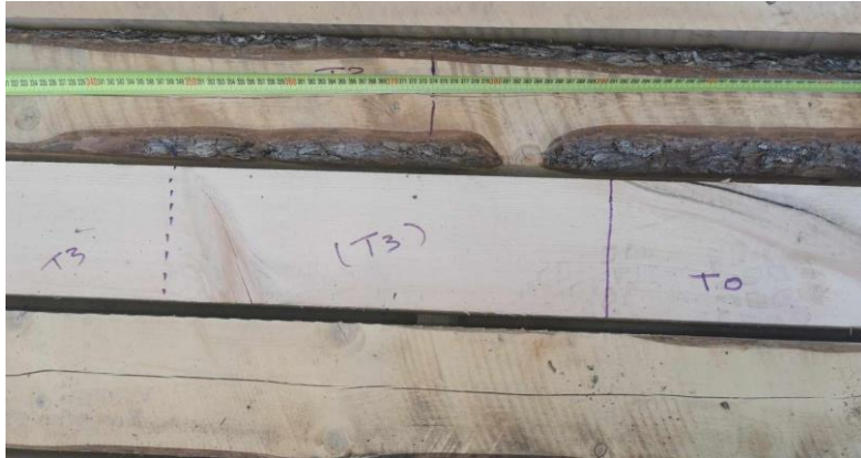
Bilde 5: Gankvist, hornkvist og foreslått plassering av kapp av 10A-B.4, foto: Silje Hoem Johansen
