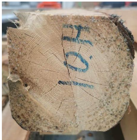
Bilde 11: Soppdannelse av overflate på ende 10H, foto: Silje Hoem Johansen
