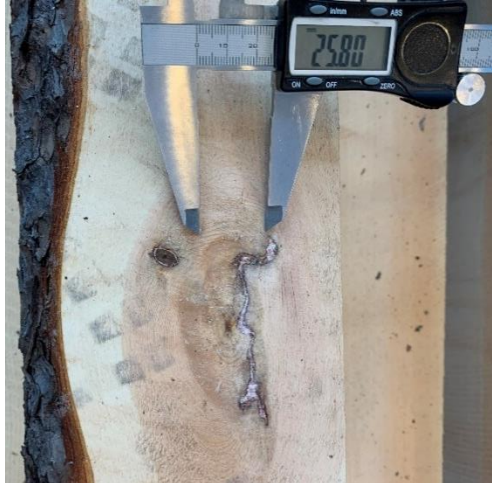
Bilde 12: Kvist over 1/5 av trevirkets bredde av 12A-B, foto: Silje Hoem Johansen
