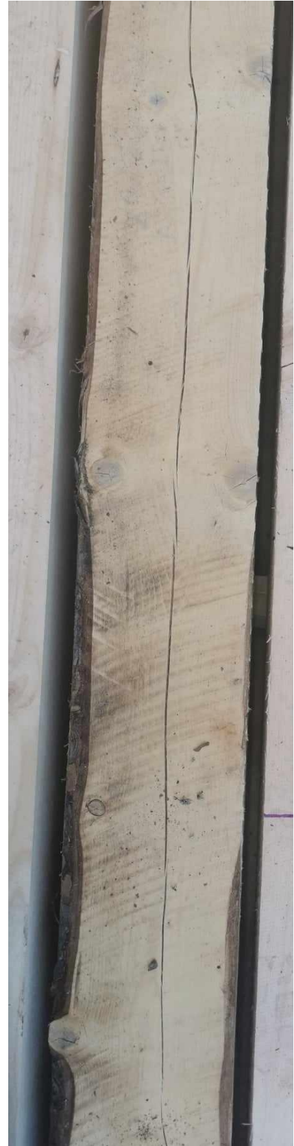
Vedlegg 10: Tørkesprekker i lengderetningen (foto: Silje Hoem Johansen)
