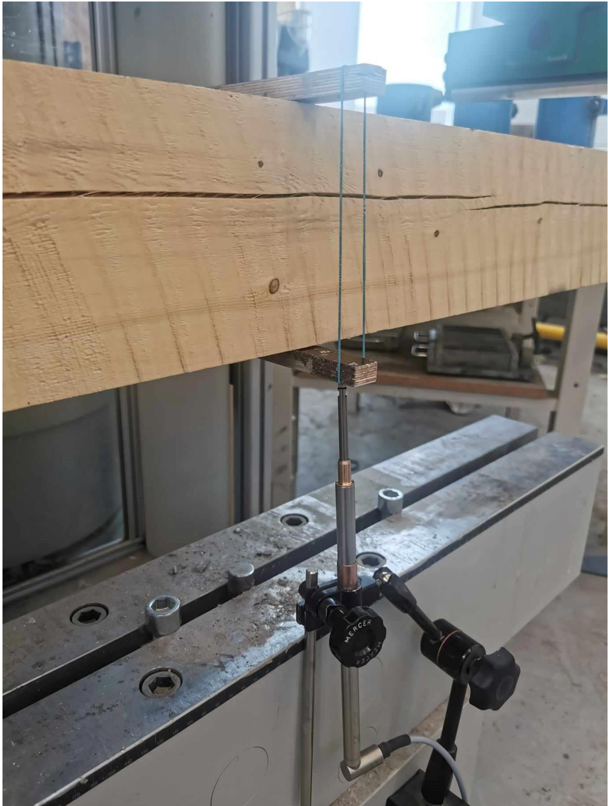
Vedlegg 11: Uavhengig nedbøyingssensor på trevirke med tørkesprekker i lengderetningen (foto: Silje Hoem Johansen)
