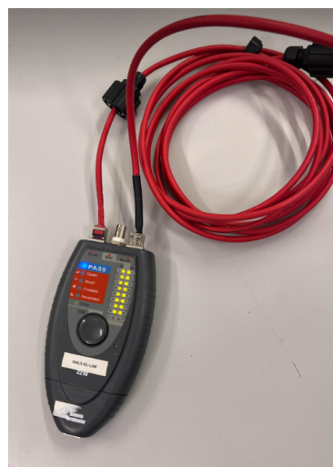
(c) Test av kabel
