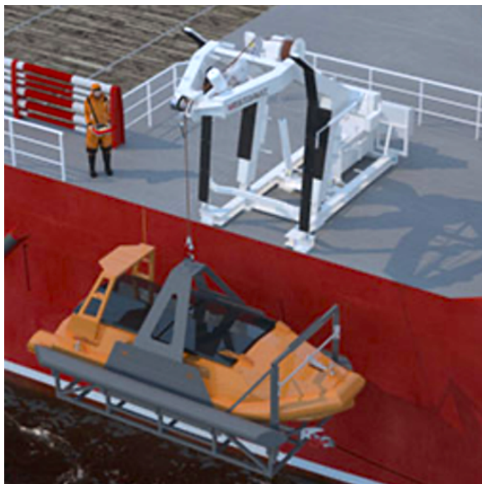
Figur 7: Illustrasjon av Mariner med tilhørende LARS-system under "launch and recovery" fra moderskip (VESTDAVIT 2024)
