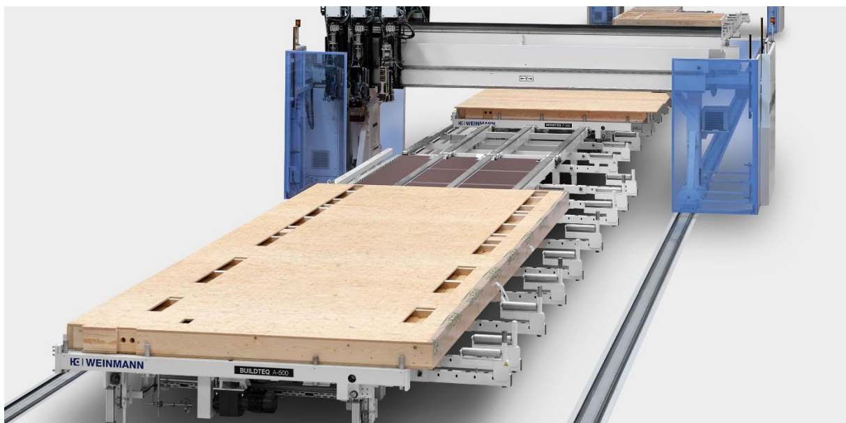
Figur 4: Bilde av deres BUILDTEQ A-500, bord for elementbygging (Homag, u.å.).
