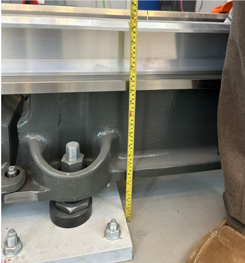
Figur 33: Høyde på skinnegangskinnegangen
