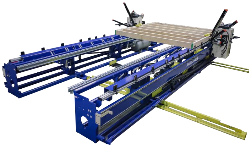
Figur 5: Bilde av Panel Plus sin monteringsjigg (Panels plus, u.å.).
