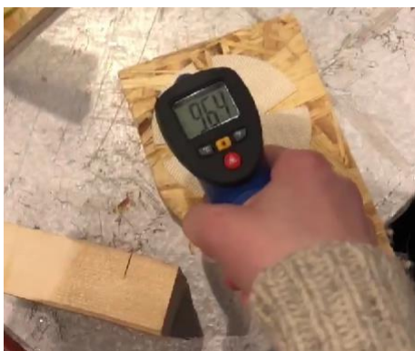
Figur 15 Temperaturmåling med IR-termometer
