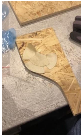
Figur 17 Brettet rondell etter oppvarmingstest
