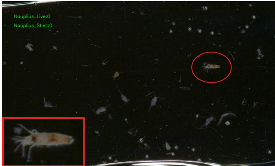
Figur 13. Tydelig uidentifisert nauplius 1, nærmest identisk gjenkjenningen av YOLO-modellen på 87% noen bilder etter. Hvit partikkel i bakgrunnen kan forstyrre gjenkjenningen (Merd 1 prøve 1)
