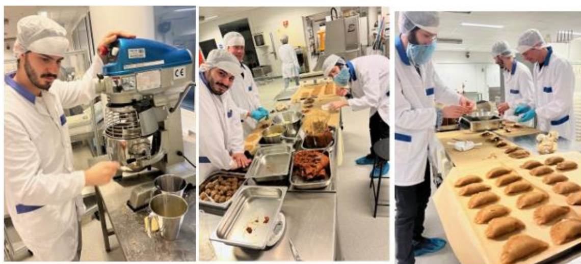
Figur 15: Bilde fra oppskalering dag 1 og 2. I første bilde anvendes planetarisk mikser til tillaging av empanadadeig. I andre bilde er det fra venstre til høyre: porsjonering og pressing av deigballer, tilførsel av ratatouille, kjøtt- og vegetabilfarse og de tre fyllene. Empanadaemner ble deretter presset i empanadapresse før de ble plassert på stekebrett og penslet med eggeplomme.
