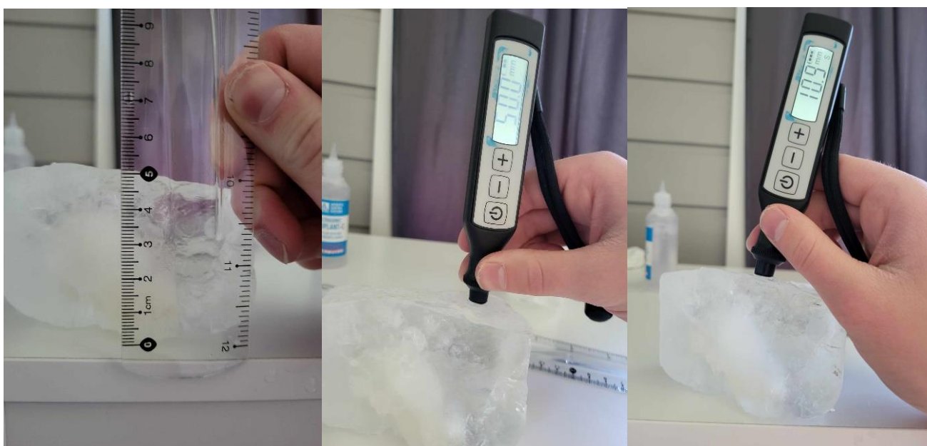
Figur 13: En 5cm blokk er vist til venstre, med luftrom og forurensning ca. 1,1cm fra overflaten. Bildet i midten måler over klar-is. Til høyre er en måling over luftrommet. Alle tre bilder er tatt av Raul Mindru, 14.05.24
