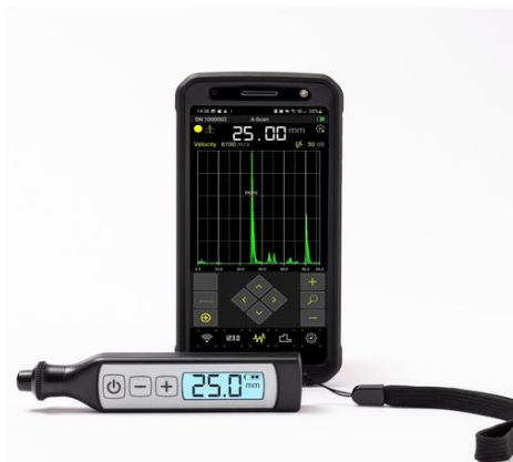
Figur 7: Pengauge for måling av tykkelser, hentet fra https://acs-international.com/product/pengauge/ 30.03.24
