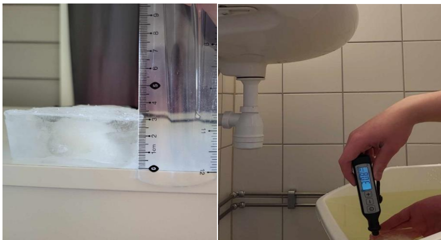
Figur 15: Til venstre bilde av en 3cm isblokk. Til høyre: samme isblokk ble lagt i vann for å teste sensoren. Bildet tatt av Raul Mindru 18.05.24
