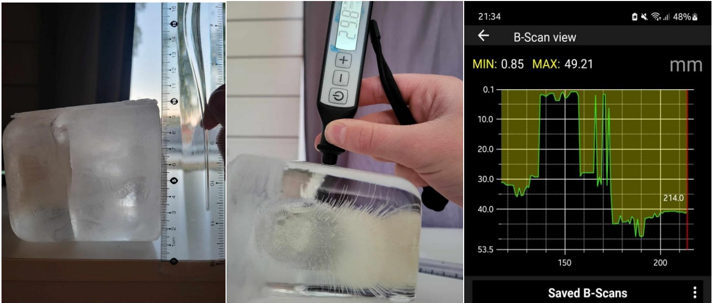
Figur 14: Til venstre isblokk med tykkelse 11 cm. I midten samme blokk brukt til å profilere dybdeforskjeller av luftrommet. Til høyre B-Scan av dybdeforskjellene. Skjermdump tatt av Raul Mindru 16.05.24
