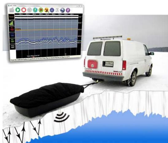
Figur 3: IceMap™ sanntidsvisning viser automatisk detektert bunn av isen (blå linje) i sanntid. Brukere kan sette en minimumstykkelsesterskel for advarsel (gullinje) hentet fra: https://www.sensoft.ca/products/icemap/overview/ , 20.02.24
