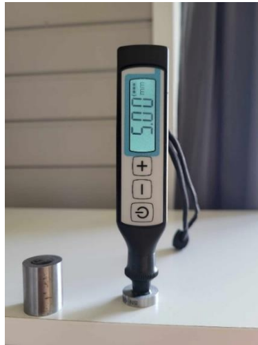
Figur 12: Kalibrering av A1207, til venstre 25cm kalibreringsblokk til høyre 5cm kalibreringsblokk, bilde tatt av Raul Mindru, 15.05.24
