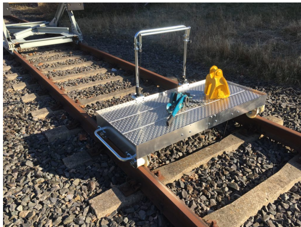
Figur 3: Eksempel på tralle for transport av utstyr (AS Fredrikstad 2024)
