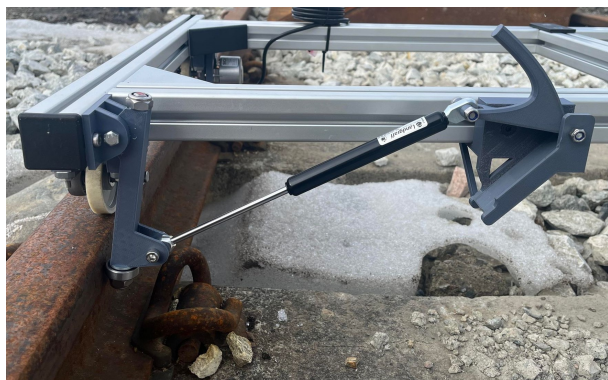
Figur 24: Foto fra testing av strammemekanisme
