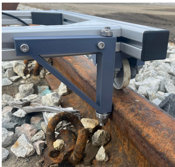
Figur 25: Foto fra testing av strammemekanisme
