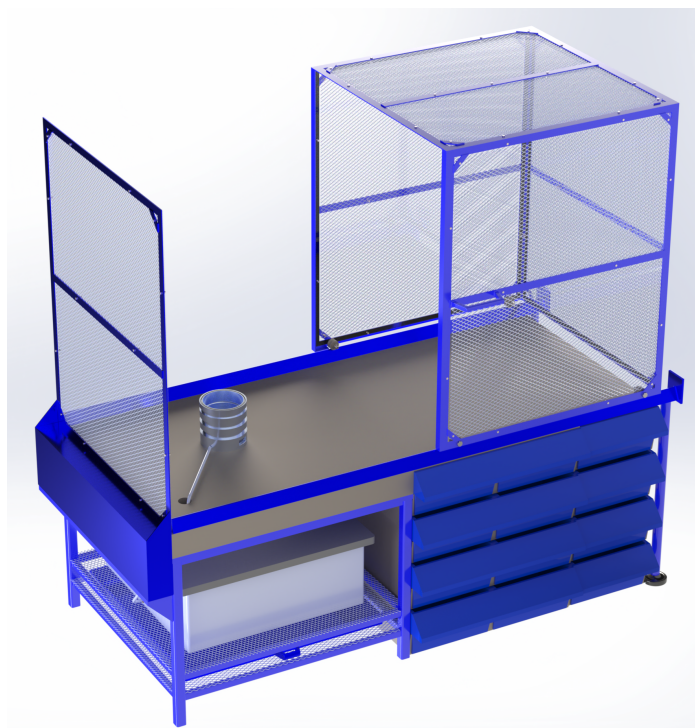
Figur 6.7: Endelig konsept for trykktester. Med påmontert beholder for Matrix.
