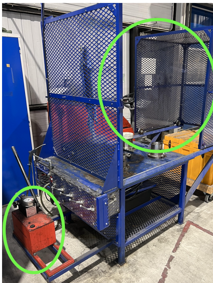
Figur 2.8: Figur av nåværende trykktester der det har blitt merket flere deler av systemet som enkelt kan automatiseres for å gjøre prosessen mindre avhengig av menneskelig innblanding.
