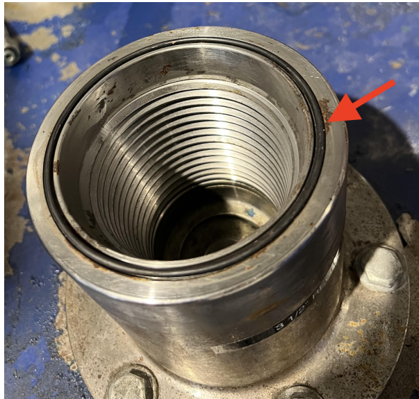
Figur 2.10: Gjengene på innsiden av bordkoblingen der borekronen skal skrues inn for testing. O-ring merket med pil.
