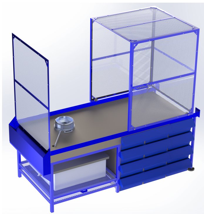
Figur 6.8: Endelig konsept for trykktester. Med påmontert beholder for CWD.
