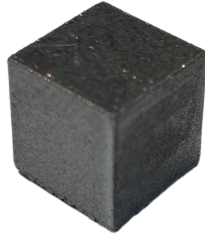
Figur 23: LPBF-produsert kube av AlSi10Mg med en størrelse på 1 cm 3
