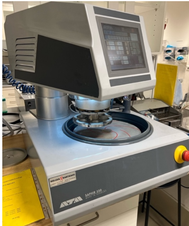
Figur 26: Metallografisk poleringsmaskin brukt til å polere alle prøvene automatisk
