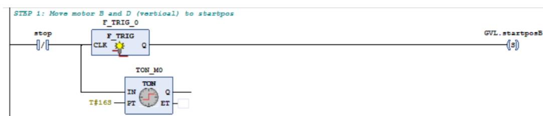
Figur 71: Et eksempel på hvordan sekvensiell styring i LD kan oppnås med bruk av bare stoppeklokke-blokker.
