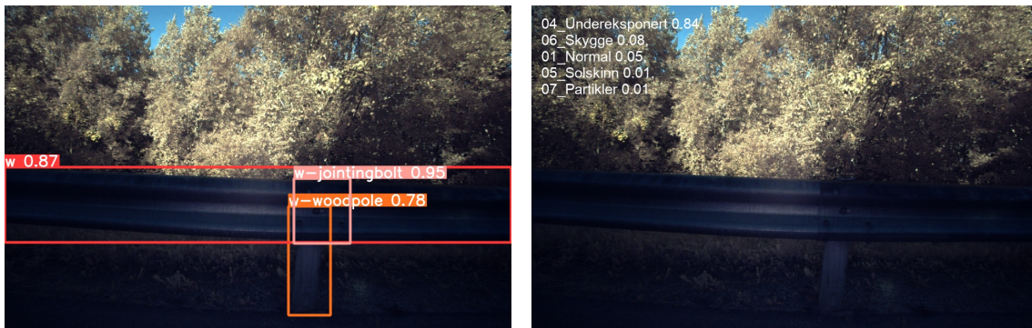
(a) Undereksponert bilde, tydet av deteksjonsmodell (b) Undereksponert bilde klassifisert av feildeteksjonsmodell
