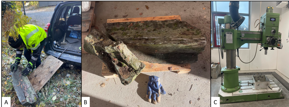
Figur 5.7: A) Bilde av veileder Bjørn Fregstad som plasserer grønnsteinen inn i bilen for trygg transport til PTS B) Bilde av de to grønnstein hentet på Steinan for å bore kjerneprøver, C) Radialbormaskinen på PTS benyttet for kjerneboring av grønnsteinen.
