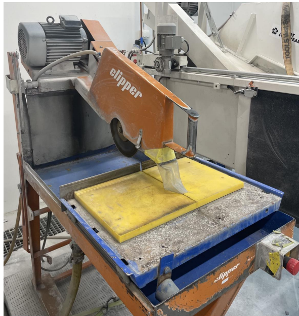
Figur 5.12: Diamantsag benyttet for å kutte til kjerneprøvene for å få egnet lengde til gjennomføring av aksial punktlasttest.
