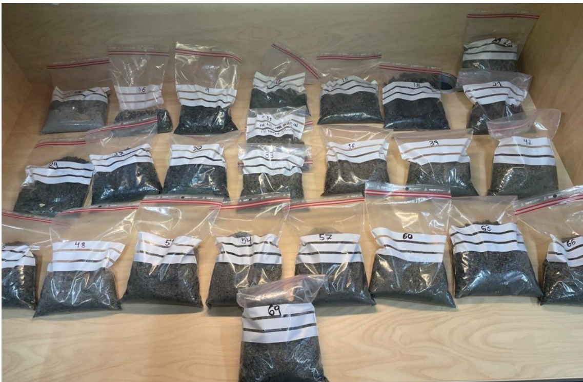
Figur 5.3: Bilde av de 25 kaksprøvene hentet inn under boringen av testbrønn 3 på Nyhavna. Størrelsen på posene er 15 cm x 21 cm.
