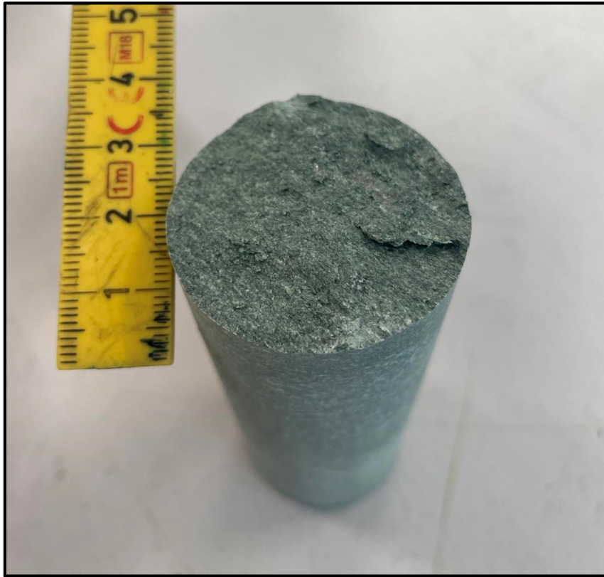
Figur 6.8: Bilde av en bruddflate etter gjennomført diametral punktlasttest. Her ser man at flaten er noe oppknust.
