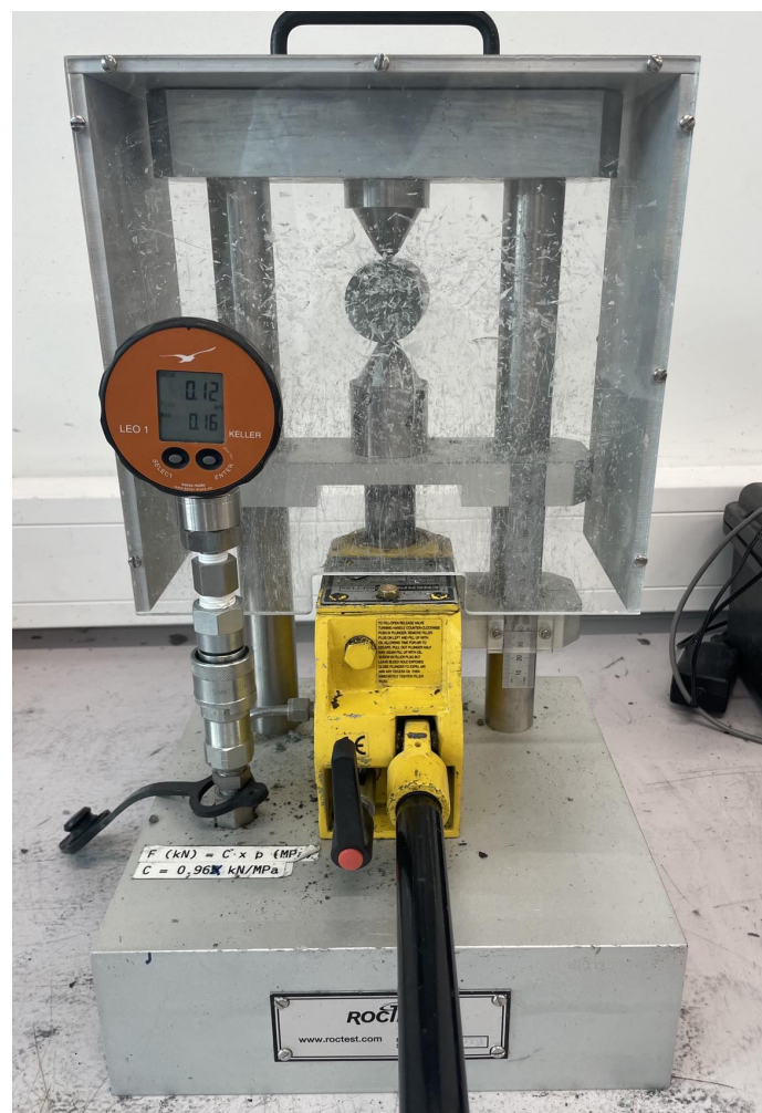
Figur 5.10: Testutstyret benyttet for å gjennomføre punktlasttestene.
