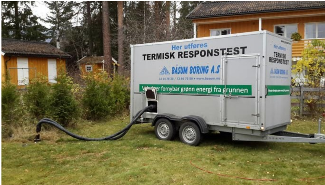
Figur 3.11: Bilde av oppsettet ved gjennomføring av en termisk responstest av et borehull (Båsum Boring, 2012).
