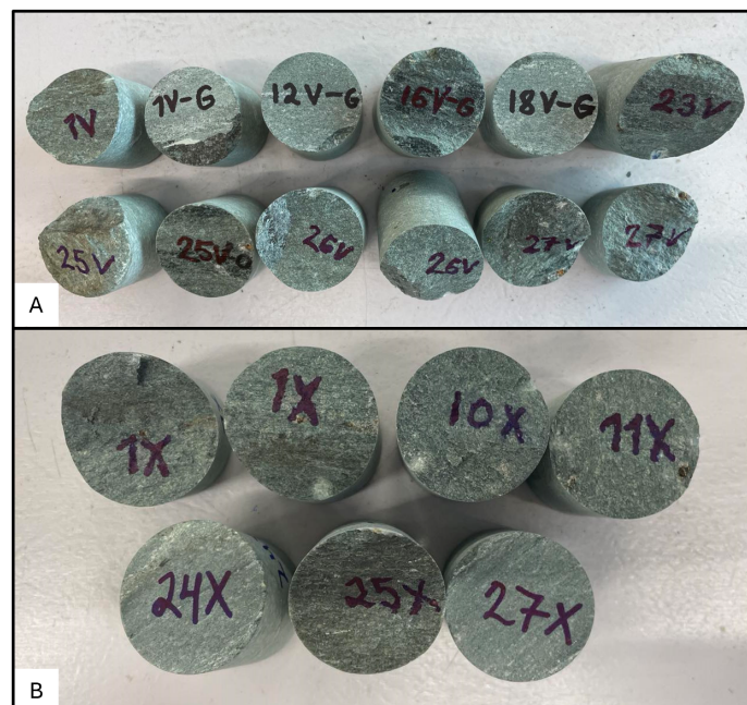
Figur 5.13: Prøver som skulle kuttet for å kunne gjennomføre aksial punktlasttest. A) De tidligere oppvarmede kjernene som skulle kuttet B) De ikke-oppvarmede kjernene som skulle kuttet. Totalt 19 prøver.
