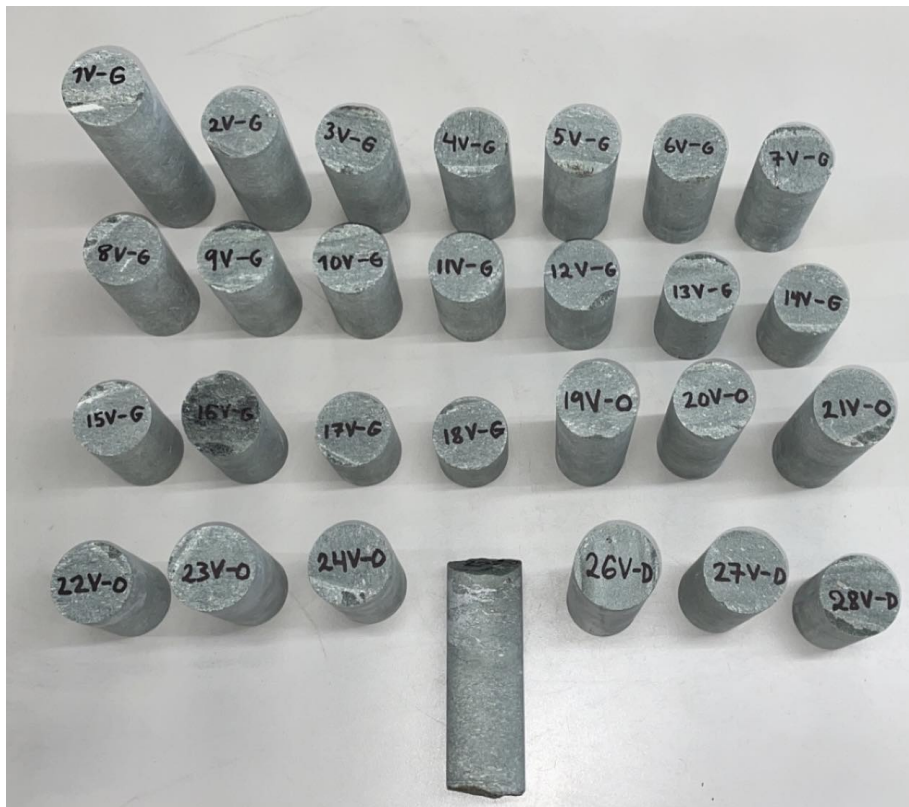
Figur 5.8: Bilde av de 28 sylinderprøvene som ble varmet opp. Kjernene ble nummerert, der V står for "oppvarming", G står for "god", O står for "ok" og D står for "dårlig". Dette var de tre inndelingene som ble satt som representerer kjernens kvalitet.
