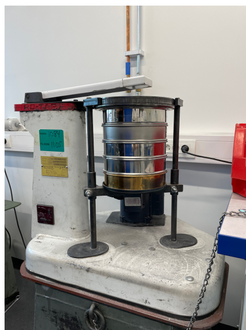
Figur 4.3.2: Ristemaskin med siktesats.
