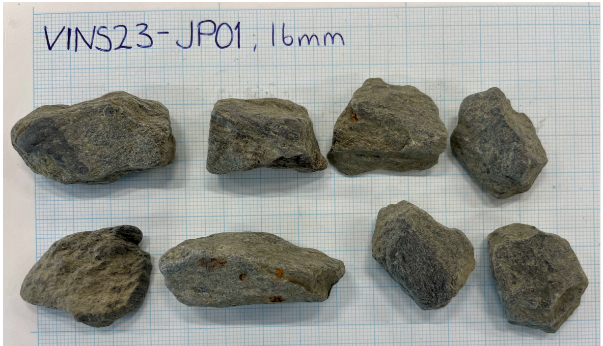
Figur D3.1: Prøve VINS23-JP01, fraksjon 16-19mm.
