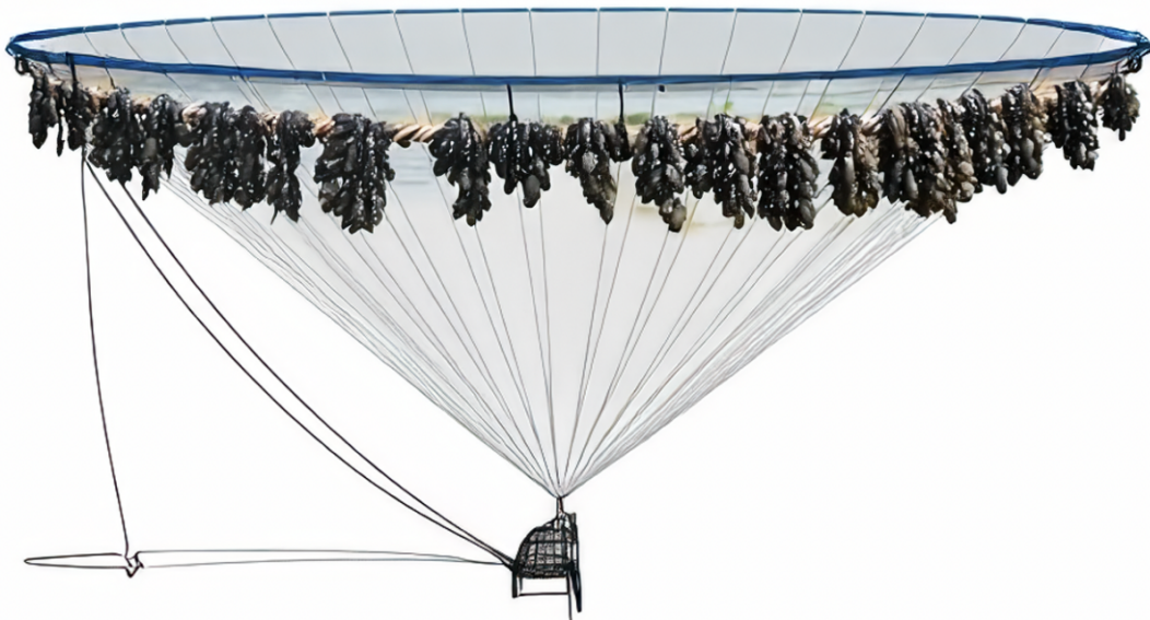
Figur 5: Illustrasjonen er generert av Adobe Photoshop - Kunstig Intelligens (Adobe Photoshop, 2024). Figuren viser ikke en realistisk oppdrettsmerd. Figuren får fram grunnprinsippet til blåskjellene rundt merden, ved at de skal henge øverste i vannmassen der lusepresset er høyest.
