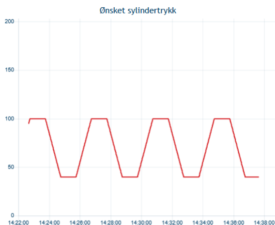
Figur 4 Skjerm bilde av graf for ønsket trykk på sylinderen. Dette visualiserer hvordan kraftsyklusprogrammet styrer sylindertrykket.
