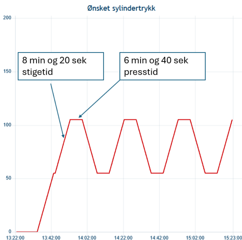
Figur 6.1: Skjerm bilde fra operatørdashboard. Figuren viser at pressen skal svinge i mellom lavt trykk på 55 bar og høyt på 105 bar. Presstiden skal være 5 minutter og stigetid 10 minutter. Da det er 500 steg imellom grensene i PLS-programmet og 600 sekunder i stigetid, får man et avvik på 100 sekunder. Rate-parameteren kan ikke være lavere enn 1.
