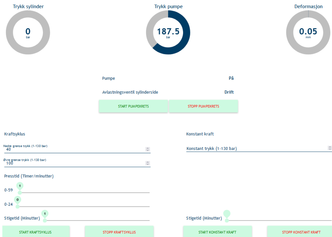
Figur 5.3: Skjermbildet viser hvordan operatørdashbordet ser ut etter pumpekrets er startet og ønskede parametre er fylt ut. I tillegg har trykket på pumpesiden kommet over 160 bar, slik at en test kan starte. I denne situasjonen er trykket simulert.
