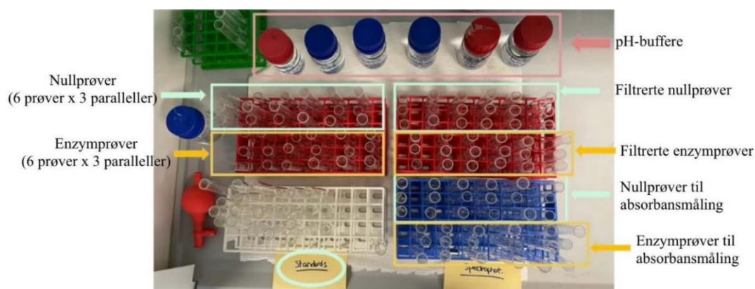
Figur 14. Oppsettet av glassrørene for måling av proteolytisk aktivitet. Rørene øverst til venstre ble brukt først, deretter ble løsningene filtrert over i de korte rørene øverst til høyre. Videre ble rørene nederst til høyre brukt til Lowry metoden for absorpsjonsmåling. Rørene nederst til venstre ble brukt til standarder. I tillegg var det et ekstra brett for prøvene fortyknet 1:200 og 1:500. Bilde fra Maria A. M.
