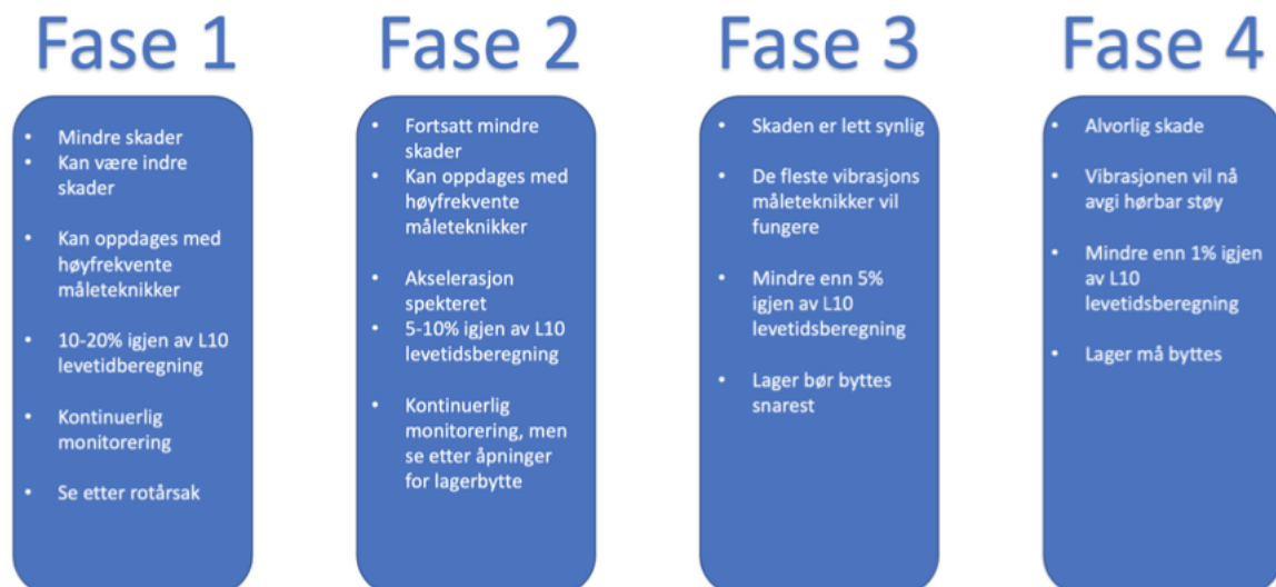
Figur 2.13: Fire faser av lagerskade(MobiusInsitute, 2016)
