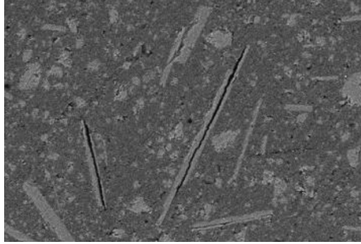
Figur 18: Utklipp fra 13f. Her kan det tydelig observeres to sprekker. Den til høyre ligger åpenbart mellom to GF. Den til venstre er vanskeligere å fastslå; den kan også ligge mellom GF og epoxy.
