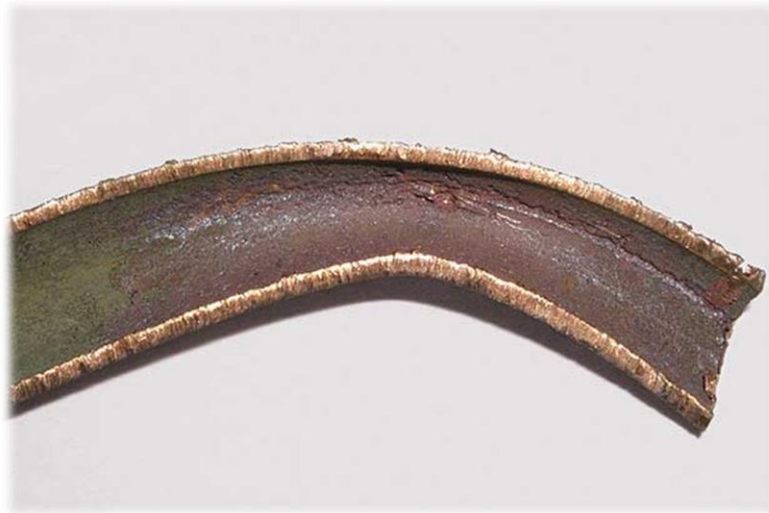
Figur 8 - Errosjonskorrosjon av kobberør [7]
