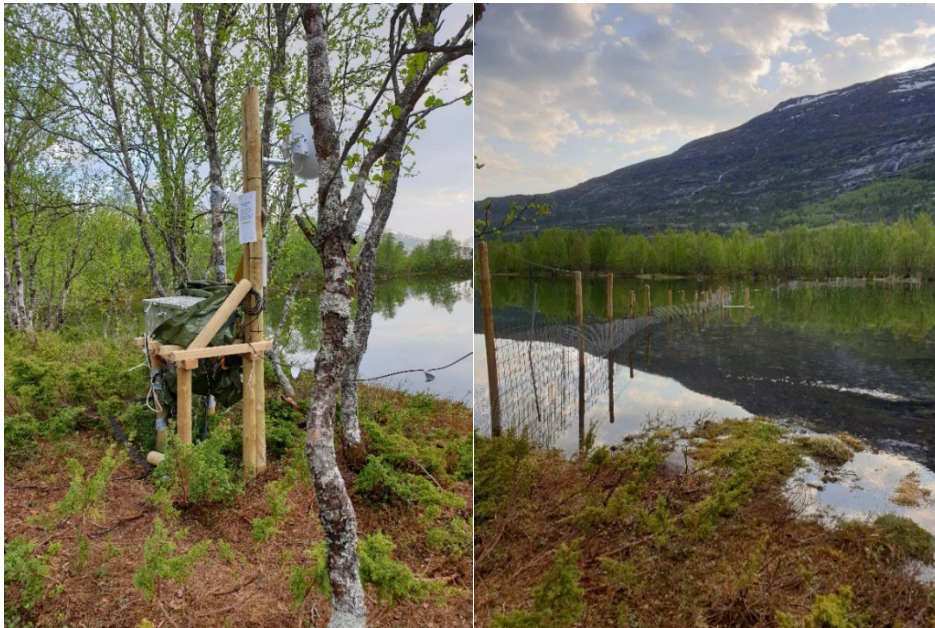
Bilde: Videoutstyr på land med mottaksantenne for internett (t.v.). Ledegjerde og videotunnel ferdig satt opp på relativt høy vannføring i mai 2022 (t.h.). Foto: Aslak Darre Sjørnsen.
