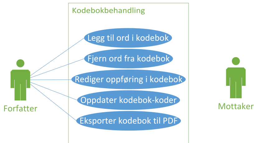
Figur 2.2: Use case-diagram: Kodebokbehandling
