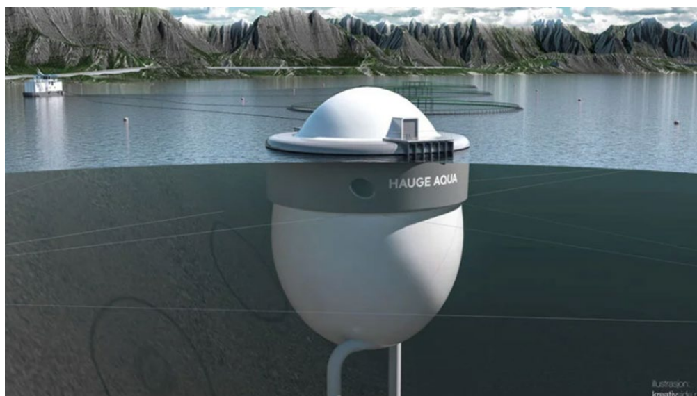
Figur 21.27. Egget® (ovum) er et lukket oppdrettskonsept for bruk i fjordbasert havbruk. Konseptet har fokus på lus/alger, rømming, oppsamling av slam, predatorer, arealutnyttelse og vannstrøm for mosjonering av fisken. Vann pumpes fra dypet, oksygeneres og strømssettes.
