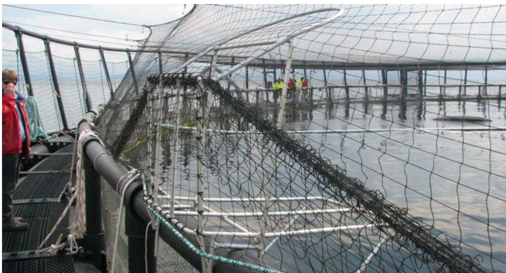
Figur 21.20. I Tasmania benyttes merder med en omkrets på 240 meter som ligger på svært eksponerte lokaliteter. De har store utfordringer med sel og vi ser her at predatornettet til venstre i bildet er som en vegg 2,5 meter over vannflaten og fortsetter under hele nota som en ekstra pose. Her er altså to lag med nøter under vann, som gir store krefter i sving når bølgene slår inn over anlegget. Her i Storm Bay. Solid fuglenett er sydd sammen med den indre fiskenota. Vi ser Fortress Pens F240.
