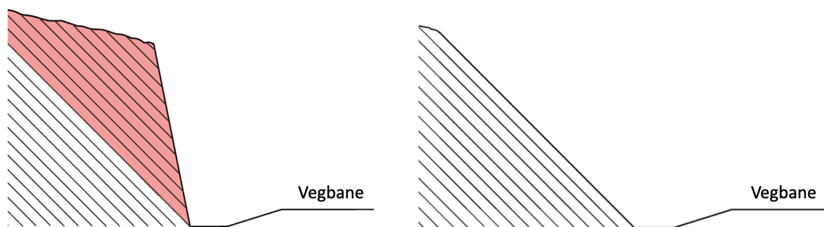
Figur 4.2: Enkel illustrasjon av bergskjæring med helning tilpasset dominerende sprekkeplan i bergmassen. Egen figur inspirert av (Moen 2021).
