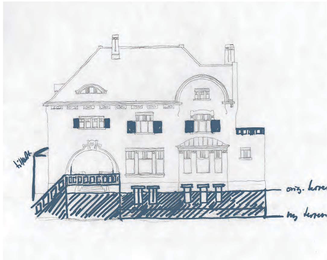
Fasadelementer som var annerledes fra tegning. Mest merkbart var trappen som var lagt til inngangen, samt at terrenget foran var tatt ned.
