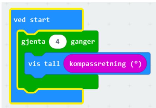
Figur 3: Eksempel på blokker som passer sammen i MakeCode
