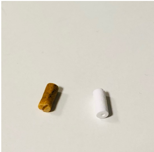
Bilde 1: Ved bytte av pumpefilter ble det gamle pumpefilteret (til venstre) sammenlignet med nytt pumpefilter (til høyre).
