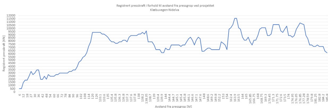
Figur 49: Forløp av generert presskraft ved prosjektet
