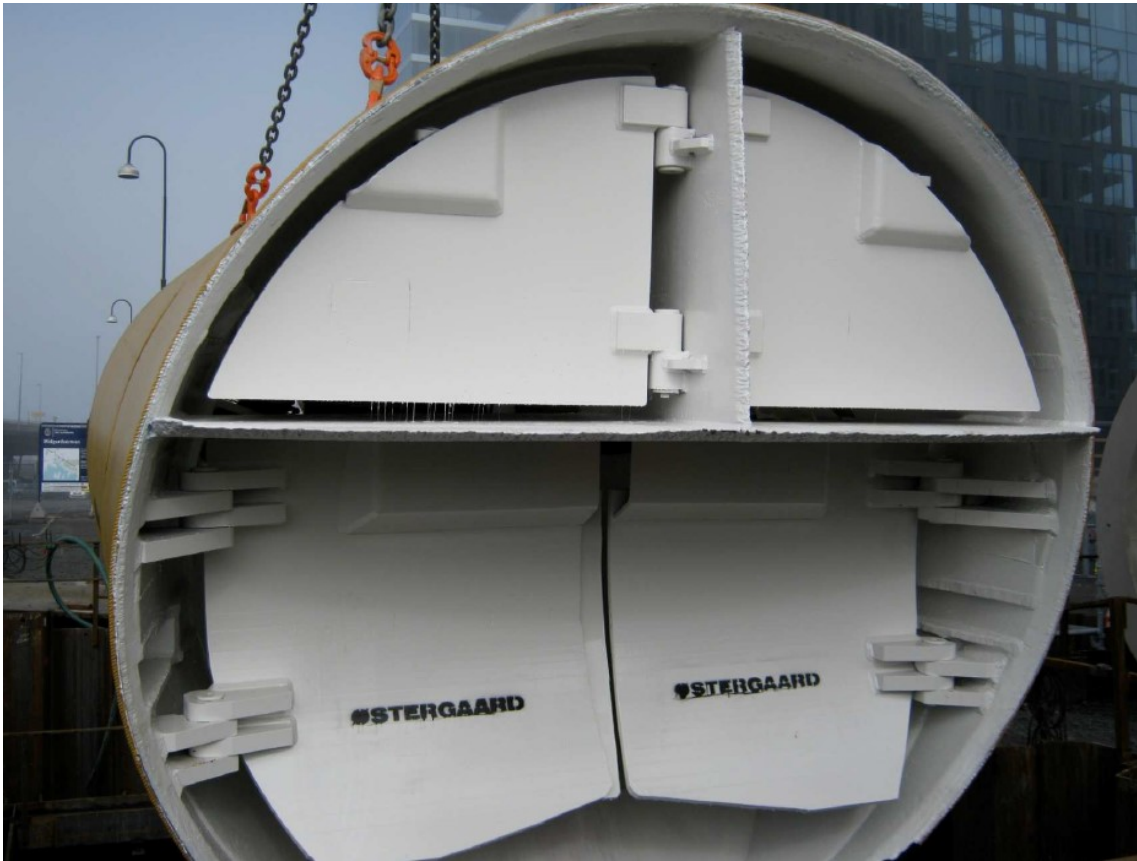
Figur 7: Tunneleringsmaskin med frontklapper kilde[14]
