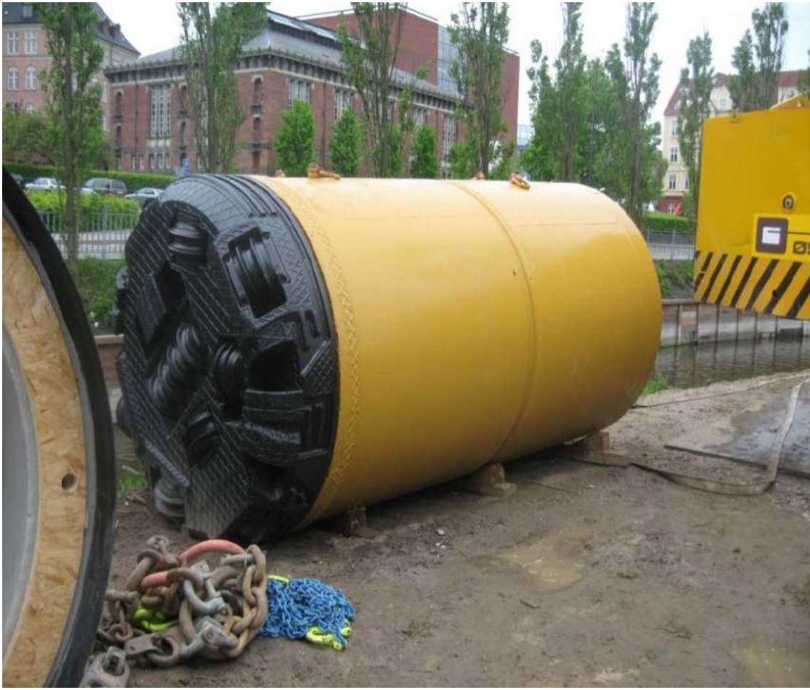
Figur 8: Startrør med lukket rørfront kilde[14]
