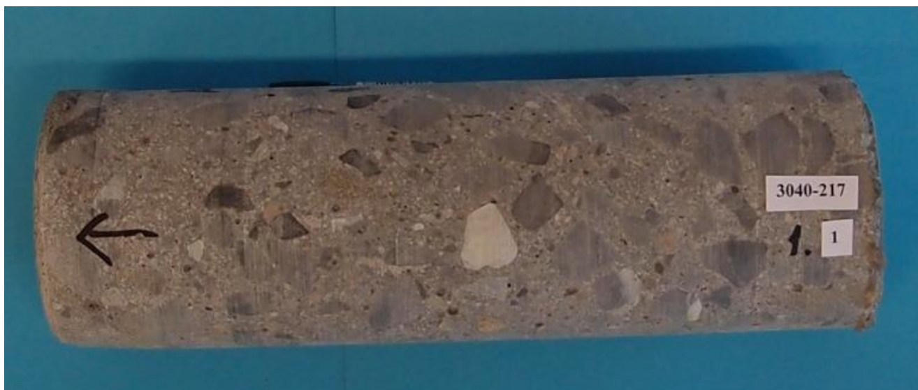
Foto nr 1. Oversiktsfoto av borkjerne nr 1 (kjernelengde 230 mm – "overflaten" (der boringen startet) til venstre på bildet).
