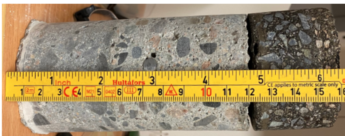
Figur 4.3.3: Størrelser på sjikt i overkant av DT-elementene. Fra venstre til høyre: 50 mm flens DT, 70 mm påstøp og 50 mm asfalt. Viser også armeringsjern med 45 mm overdekning i påstøpen.
