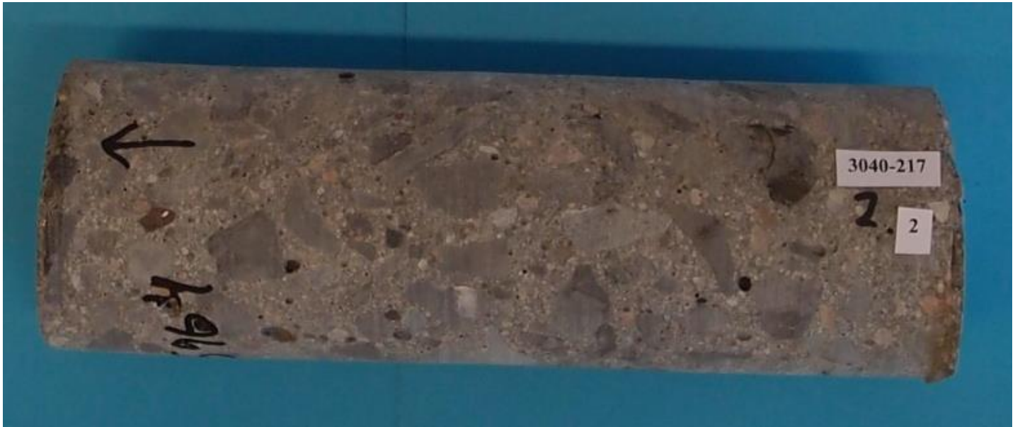
Foto nr 4. Oversiktsfoto av borkjerne nr 2 (kjernelengde 225 mm – overflaten til venstre på bildet).
