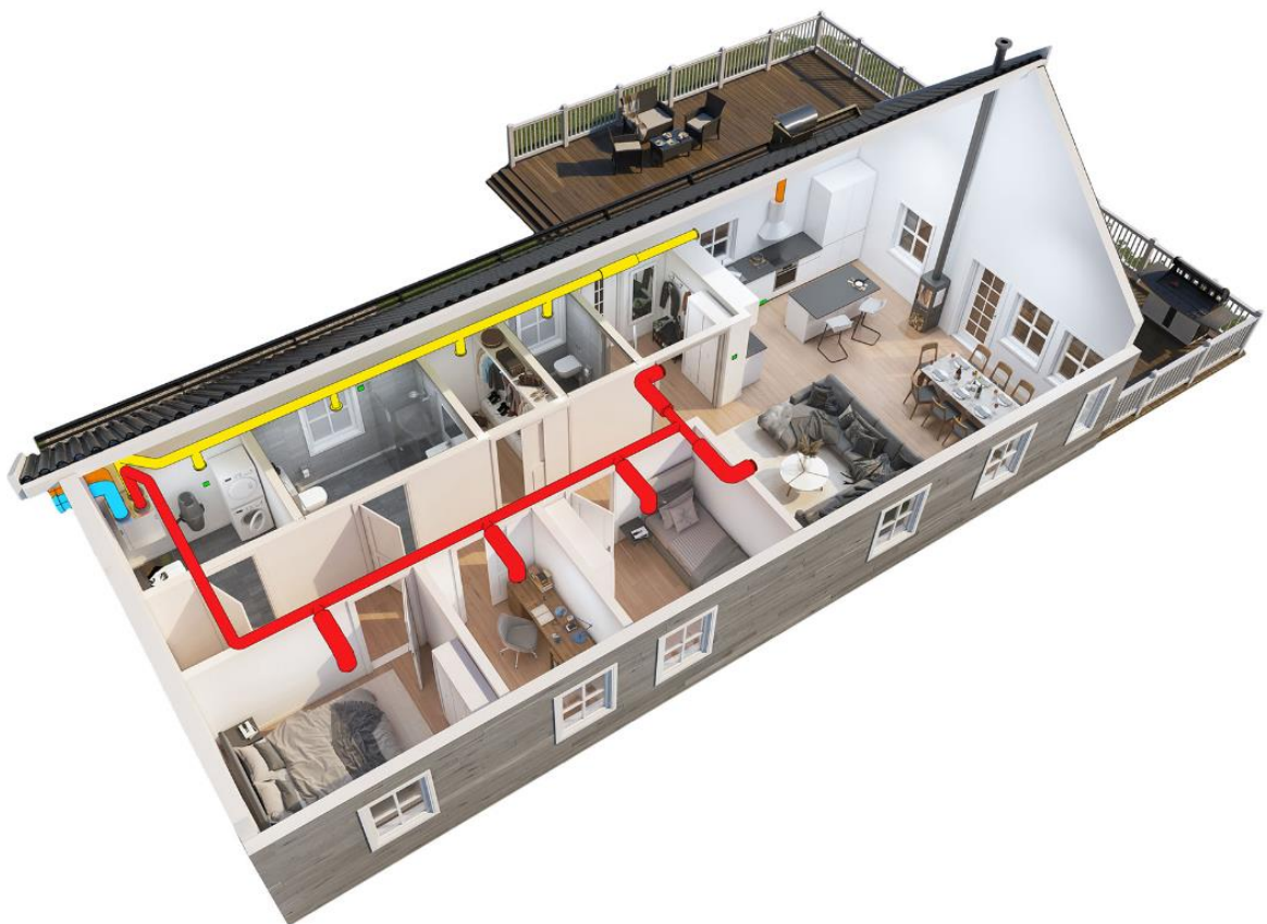
Figur 6: Balansert ventilasjon vist i 3D
