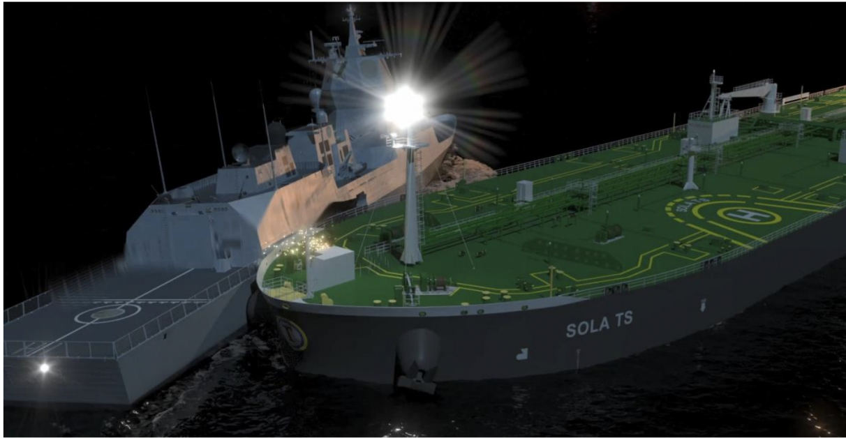
Figur 18: Kollisjonen mellom KNM Helge Ingstad og Sola TS som grafisk fremstilt viser treffpunktet, tatt fra Statens havarikommisjon (2019).
