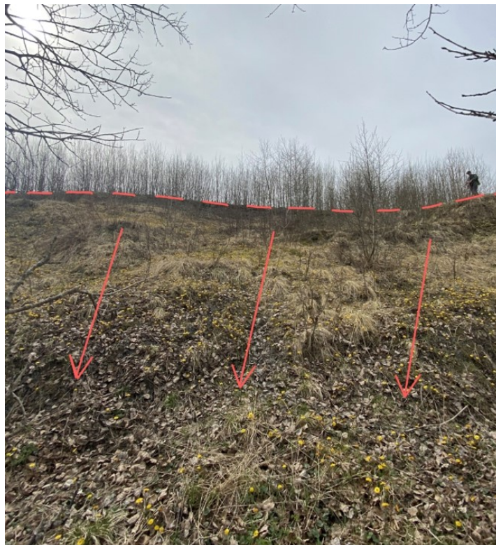
(b) Utglidningsområdet sett fra bunnen av skråningen. Rød stipletlinje viser hvor utglidningen startet og pilene viser bevegelsesretningen til massene
