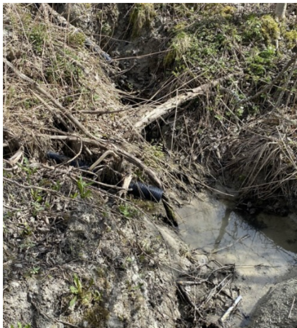
(a) Erosjon fra dreneringsrør som er lagt i forbindelse med jordbruk, like ved nedsynkningen.
