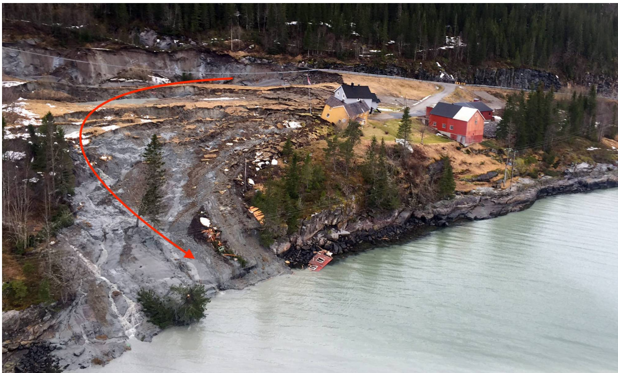
Figur 2.7: Skredet som gikk i Tosbotn i 2016 var et rotasjonsskred (Lorentsen 2016, foto: Ole-Christian Olsen).
