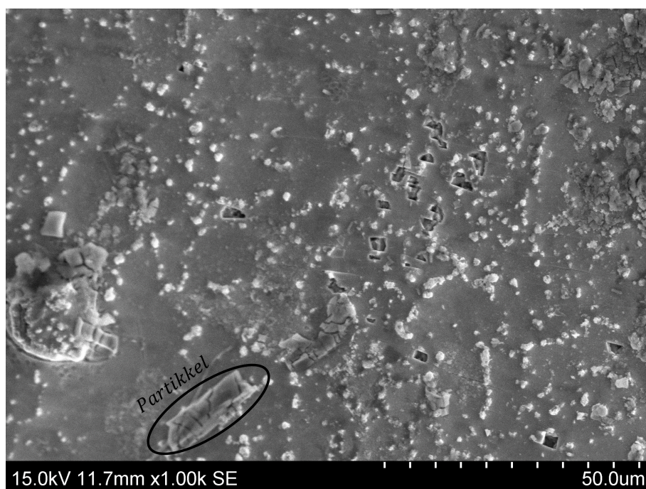
Figur 4.44: Viser et SE-bilde fra SEM (1000x) av baksiden til en industriell DSA-anode med en partikkel som ble undersøkt.
