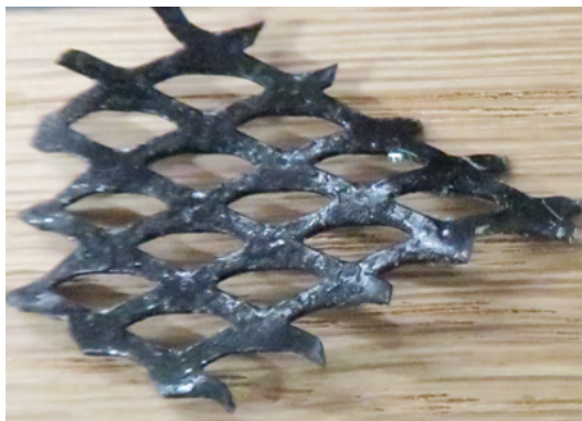
Figur 3.2: Viser en liten bit av en DSA-anode fra industrien.
