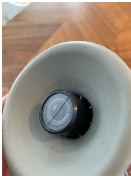
Figur 24: Sprekken i linseglasset på kameraenheten
