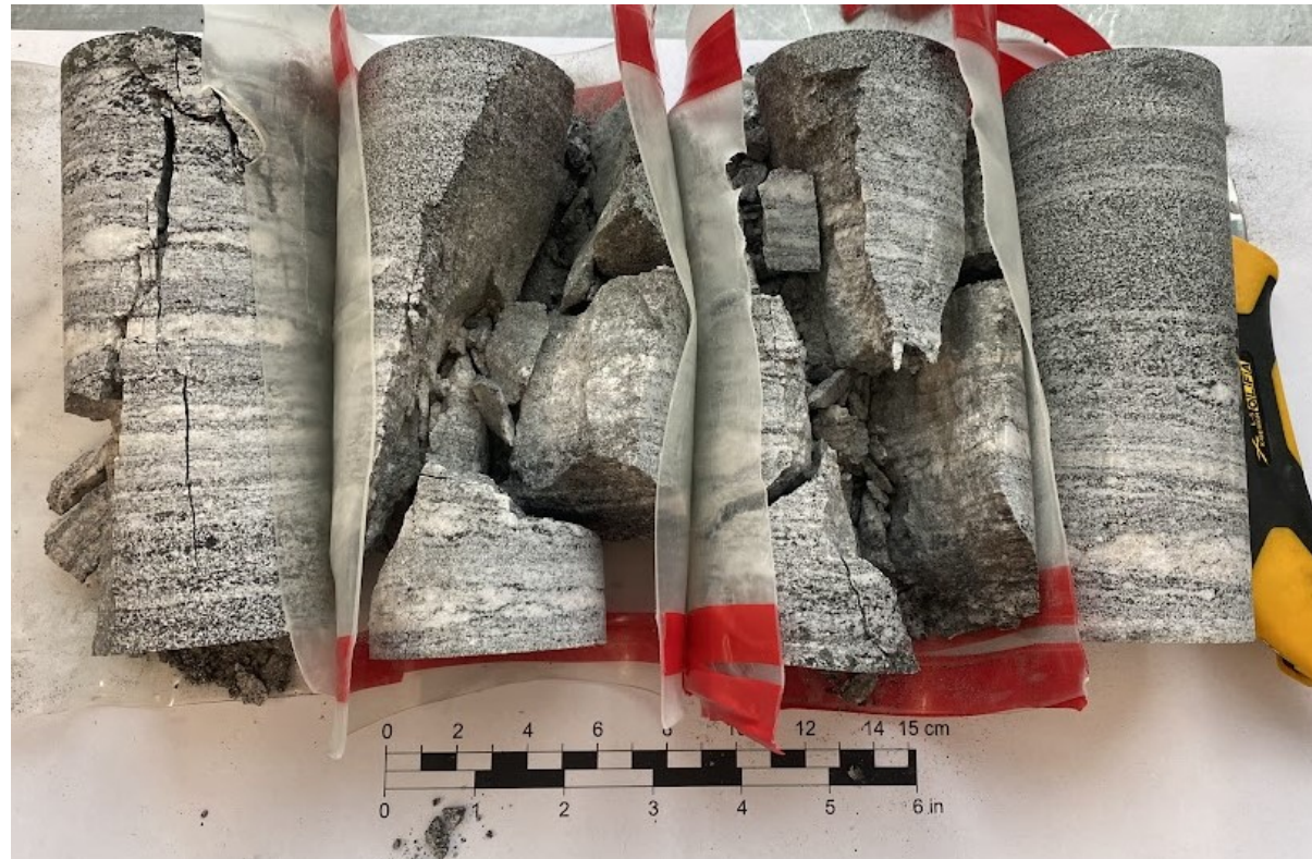
Figur A.2: UCS2-kjerner etter testing.
