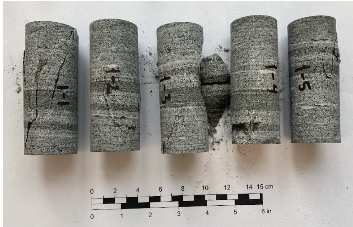
Figur A.1: UCS1-kjerner etter testing.
