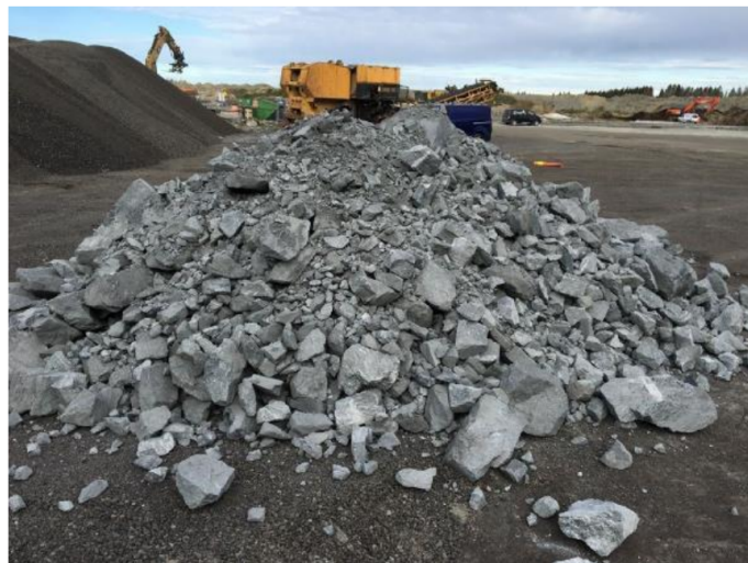
Figur 14: Sprengstein fra tunneldriving Akershusstranda. Hentet fra (Langford et al. 2020).
