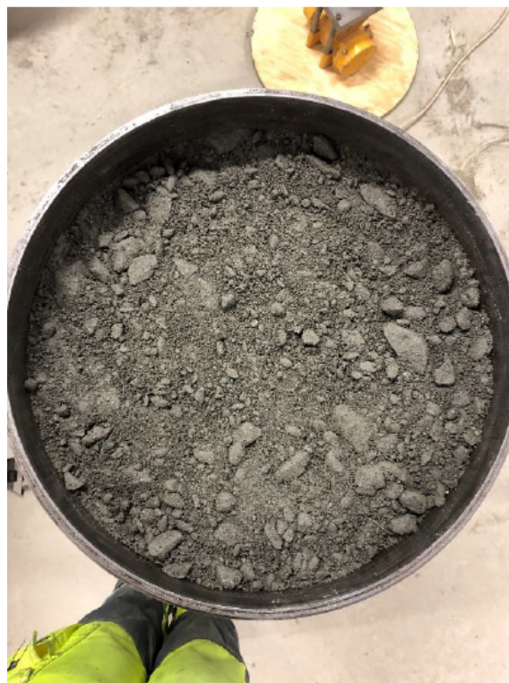
Figur 39: Bilde av TBM-massen brukt i TBM test 2. Hentet fra (Syversen 2021)
