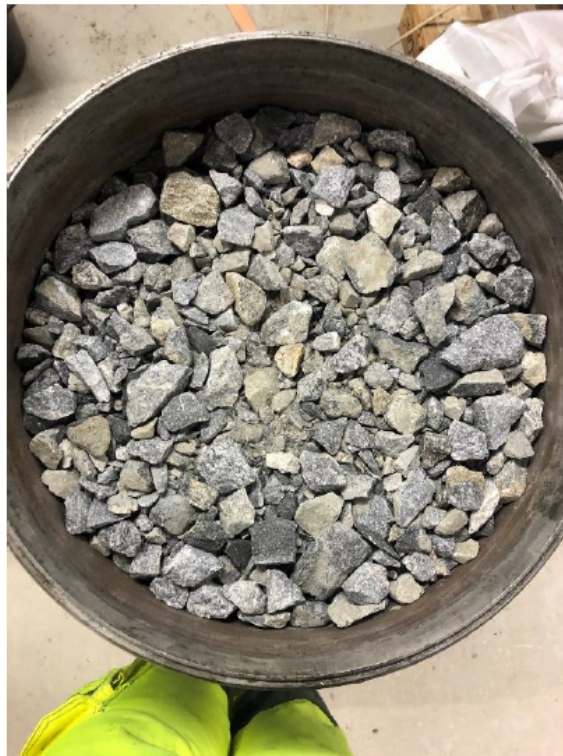
Figur 42: Bilde av den knuste steinen brukt i CR test 1. Hentet fra (Syversen 2021).
