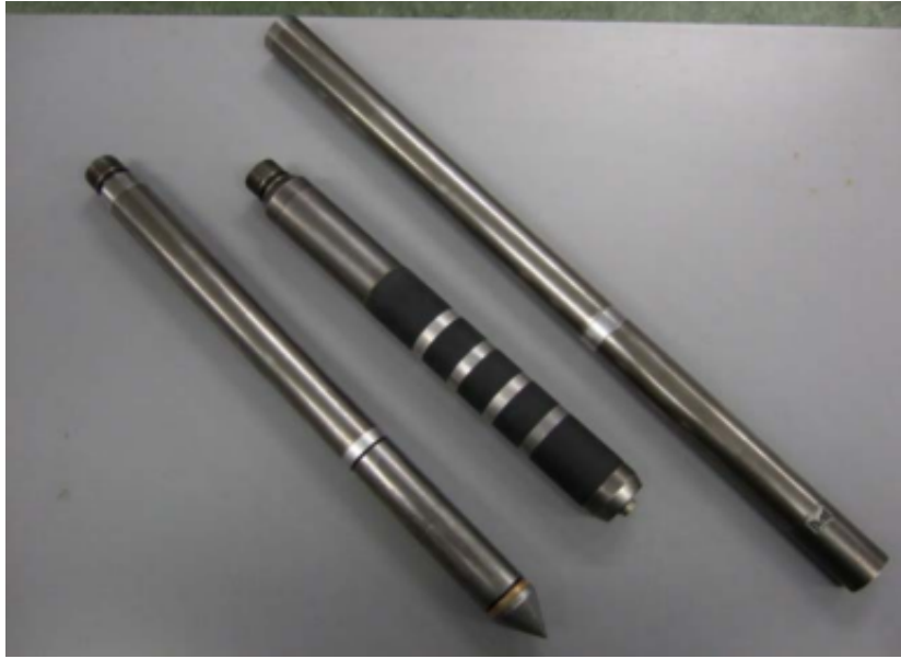
Figur 6.15: Geotech R-CPT sonde som brukes ved NTNU. Fra venstre: CPT-spiss, resistivitetssonde med 4 elektroder satt opp i Wenner elektrodekonfigurasjon og 3,5 cm elektrodeavstand, batteripakke (Aasland 2010).
