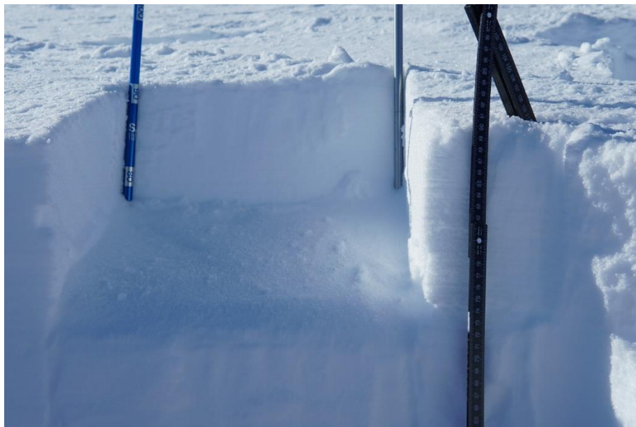
Figur 10: Snøprofil med tydelig bruddflate
