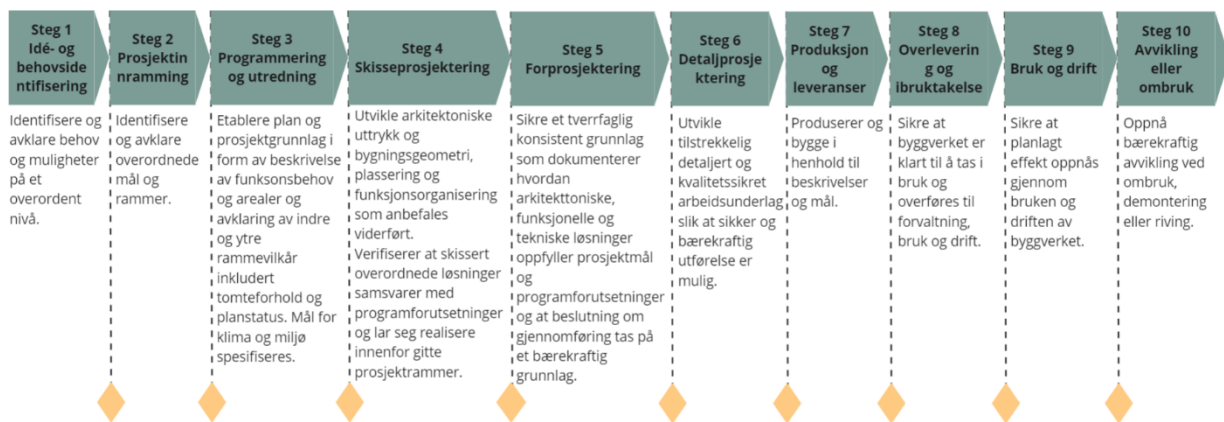
Figur 4. Stegene i byggverkets livssyklus. Illustrasjonen er utarbeidet av forfatter basert på (Standard Norge, 2023b, s. 8). Beskrivelsen i figur er hentet fra (Standard Norge, 2023b, s. 10)
