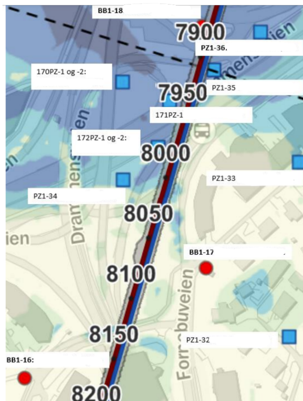
Figur 7.4: Eksempler på plassering av poretrykksmålere (blå firkant) og brønner (rød sirkel), relativt til tunneltrasé (PGF 2023)
