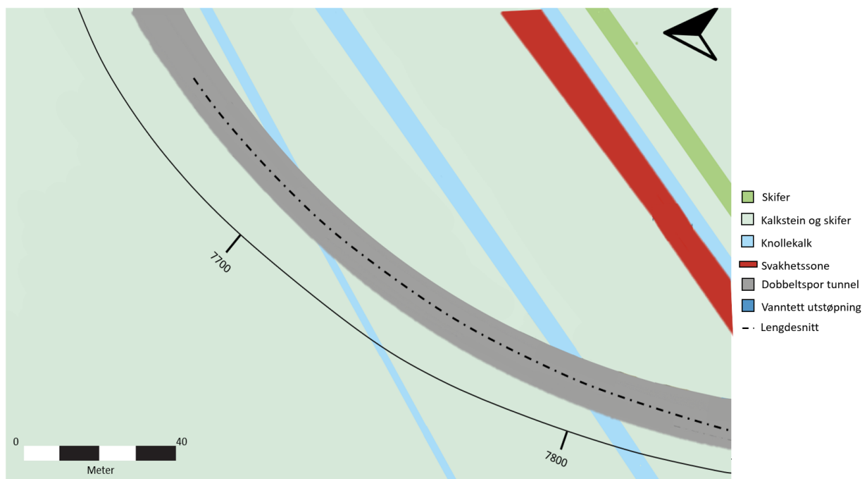
Figur 9.20: Geologisk oversikt over Hovedløp Lysaker vest med utgangspunkt i BIM-modell og bevermapping. Bergartsretning og utstrekning er tolket på bakgrunn av prosjektert lagdeling og vil ikke representere faktiske forhold utover tunnelløpet. Figuren er modifisert fra BIM-modell og BeverMapping
