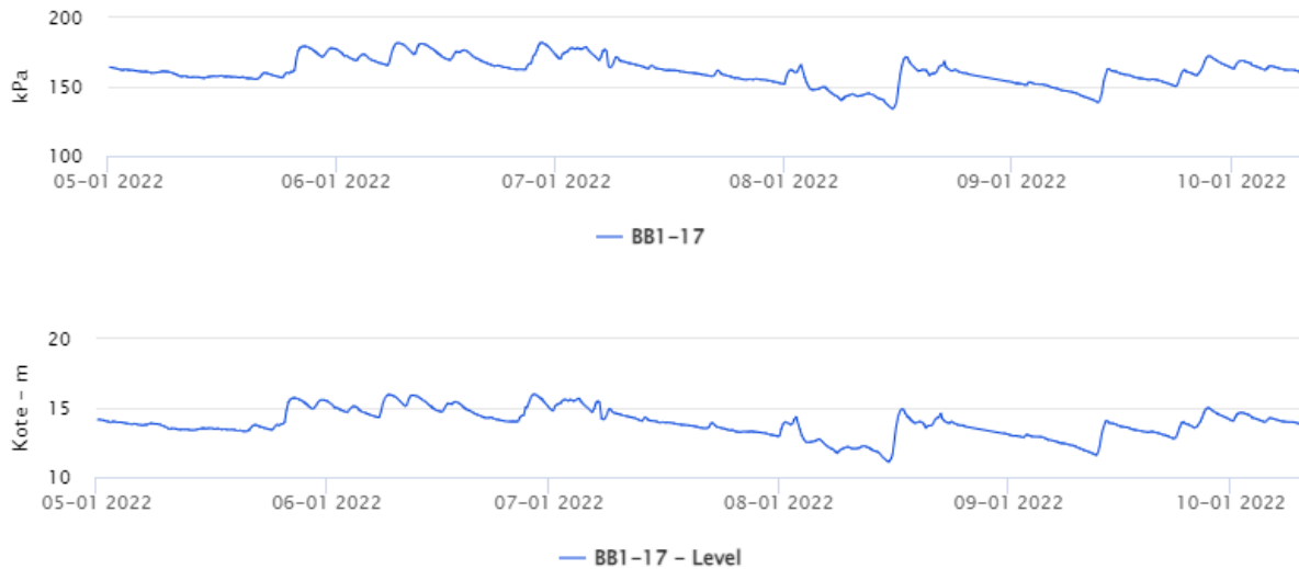
Figur 9.37: Poretrykksdata fra brønn BB1-17, illustrert ved m stighøyde. Hentet 20.05.2023 fra prosjektets poretrykksdatabase Vista Data Vision - Fornebuibanen
