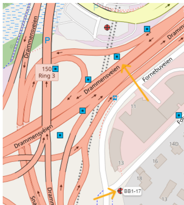
Figur 9.38: Oversikt over plassering av målere, til PS1-35 (blå firkant) og BB1-17 (rød sirkel), relativt til tunneløp i stiplet linje. Hentet 20.05.2023 fra prosjektets poretrykksdatabase Vista Data Vision - Fornebuibanen
